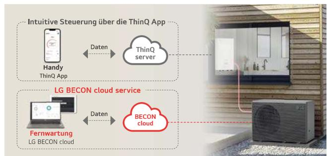
Über die ThinQ App kann die R290 Monobloc egal von welchem Ort gesteuert werden. Damit hat man die Wohlfühltemperatur sowie den Energieverbrauch immer im Blick. Und über die LG BECON CLOUD kann der Fachbetrieb sogar einen Fernzugriff auf die Anlage durchführen und in vielen Fällen den Fehler schon vor einem Serviceeinsatz vor Ort finden. Das spart Zeit und Geld.
