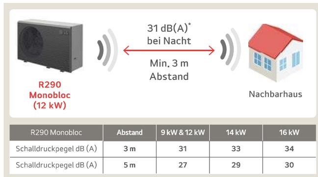
Durch die niedrigen Schallwerte der neuen LG R290 Monobloc besteht mehr Flexibilität bei der Wahl des Aufstellorts und die strengen Lärmschutzvorschriften können einfacher eingehalten werden.
