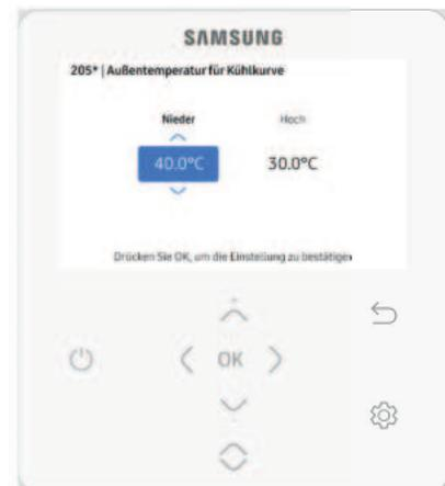
2051 auf 40°C bedeutet, dass wir bei einer Außentemperatur von 40°C die niedrigste Vorlauftemperatur im Kühlmodus fahren. Unter den FSV-Werten 2061 (FBH)/2071 (FCU) geben wir die VL min. Temperatur für FBH 18°C oder FCU (Fancoils) z.B. 6°C ein.
